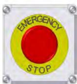
Il y a un bouton-poussoir d'arrêt d'urgence sur tous les semoirs CTHC 3000 qui se trouve sur le panneau de commande du traiteur. Les actionneurs d'arrêt d'urgence doivent être de couleur ROUGE. Le fond immédiatement autour de l'actionneur de l'appareil doit être de couleur JAUNE. Le dispositif actionné par bouton-poussoir d'actionneur doit être du type à tête de paume ou champignon.
