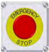
Il y a un bouton-poussoir d'arrêt d'urgence sur tous les semoirs CTHC 3000 qui se trouve sur le panneau de commande du traiteur. Les actionneurs d'arrêt d'urgence doivent être de couleur ROUGE. Le fond immédiatement autour de l'actionneur de l'appareil doit être de couleur JAUNE. Le dispositif actionné par bouton-poussoir d'actionneur doit être du type à tête de paume ou champignon.
