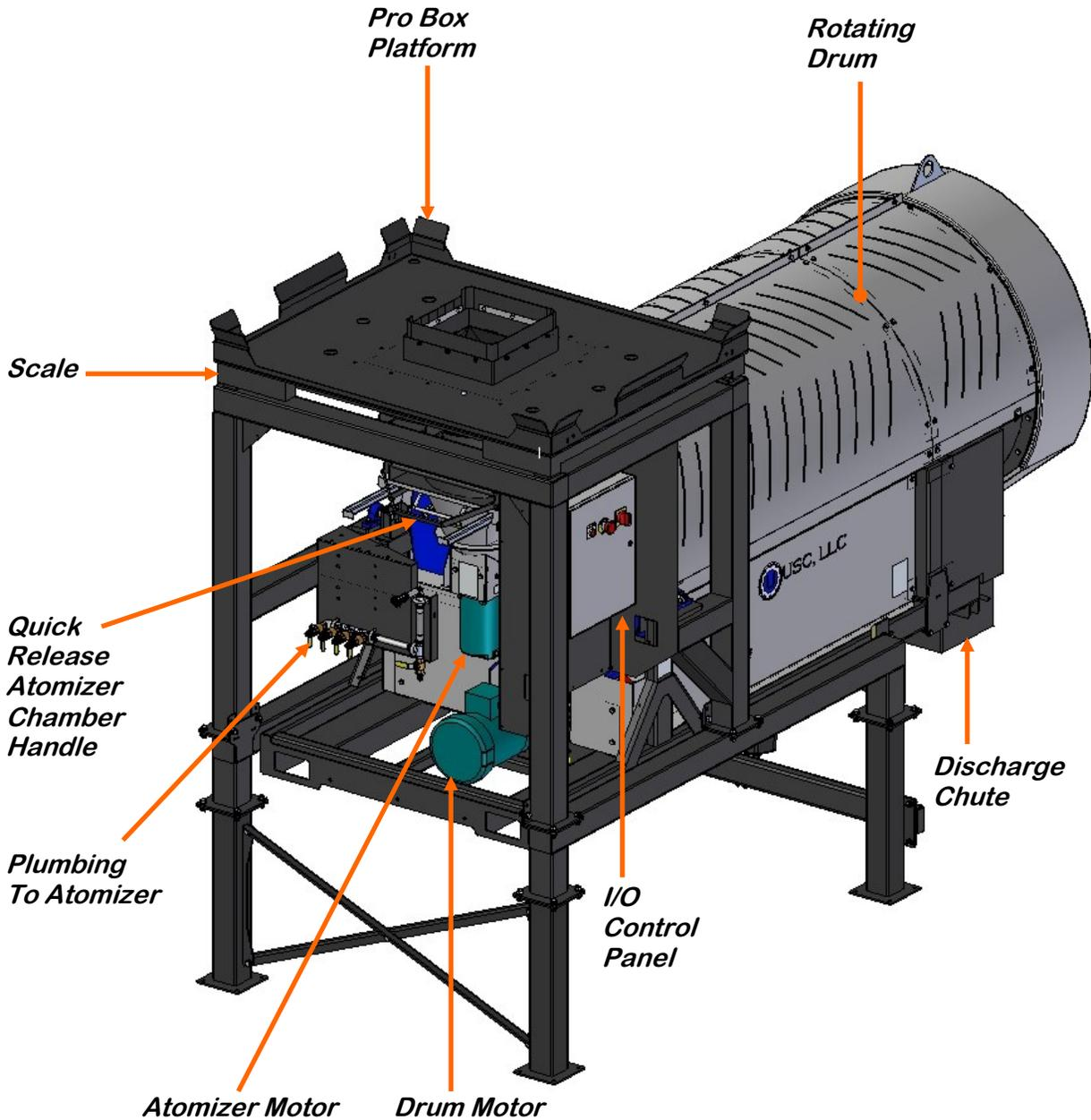
**LOSS-IN-WEIGHT WITH ATOMIZER CHAMBERS**
