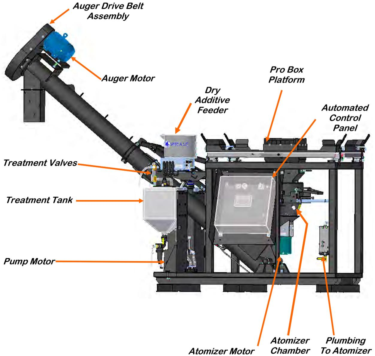
**LOSS IN WEIGHT SLIDE GATE AND ATOMIZER CHAMBER**
